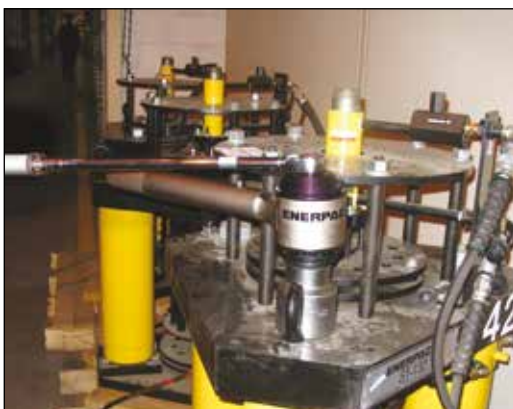
◀ Krachtvermeerderaar E393 wordt hier gebruikt voor het handmatig aandraaien van moeren tot 4300 Nm.
