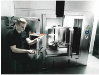
Le contrôle unitaire sous 10 000 volts conformément à la norme IEC 60900 garantit un travail en toute sécurité jusqu'à 1 000 volts.
