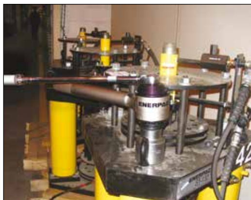
◀ Multiplicateur de couple Enerpac E393 avec barre de réaction, utilisé pour serrer des boulons avec un couple pouvant atteindre 4300 Nm.
